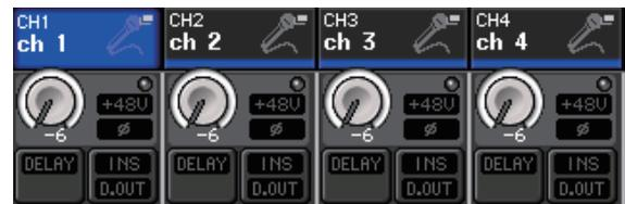
Quando si preme una manopola visualizzata nella schermata OVERVIEW, attorno alla riga orizzontale delle manopole dello stesso tipo viene visualizzata una cornice spessa. Questa cornice indica che è possibile utilizzare le manopole multifunzione della sezione Centralogic per attivare le manopole corrispondenti.
