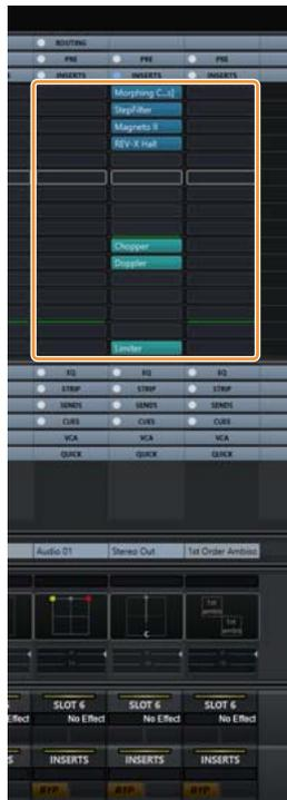
Les logements d'insertion sur les bandes de canaux peuvent être sélectionnés à l'aide de [▲] [▼] dans la section SECTION CONTROL (Commande de section).
