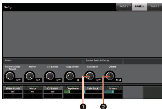
Per i pulsanti utilizzati per regolare il tempo di pressione per Smart Switch Delay, adesso il pulsante [TALK BACK] e gli altri pulsanti possono essere configurati separatamente.
