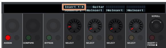
7. Ruotare il [Knob multifunzione] per selezionare l'inserimento. Il [Knob multifunzione] da azionare varia a seconda dello slot di destinazione per l'inserimento.
