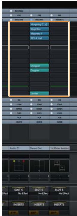
Gli slot di inserimento sulle channel strip possono essere selezionati mediante [▲][▼] nella sezione SECTION CONTROL.
