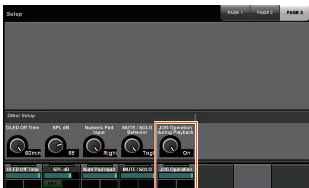
On      Consente di attivare il funzionamento di [Jog wheel] durante la riproduzione del progetto.
