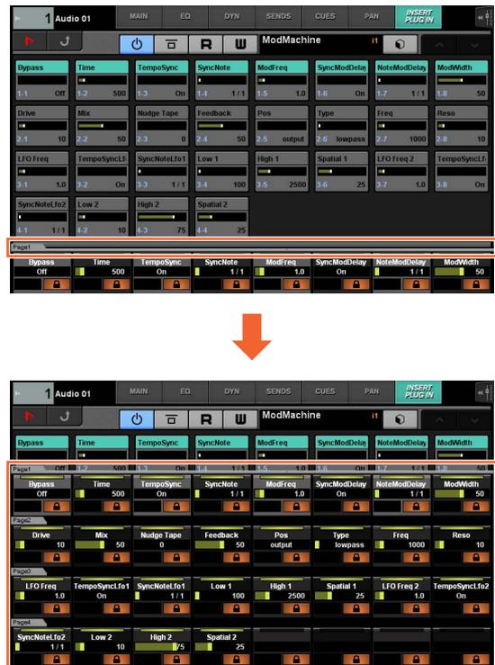
Una riga orizzontale singola indica un banco. Quando si tocca un banco, i parametri controllabili dei [knob multifunzione] cambiano nel banco corrispondente e la finestra si chiude.
