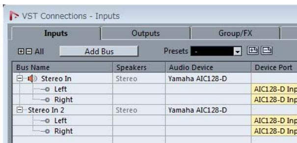
Se è stato assegnato un bus di ingresso con più canali (come i canali stereo o surround), vengono visualizzati i parametri per il canale bus visualizzato per primo in “Connessioni VST” di Nuendo (“Sinistra” per un canale stereo).
